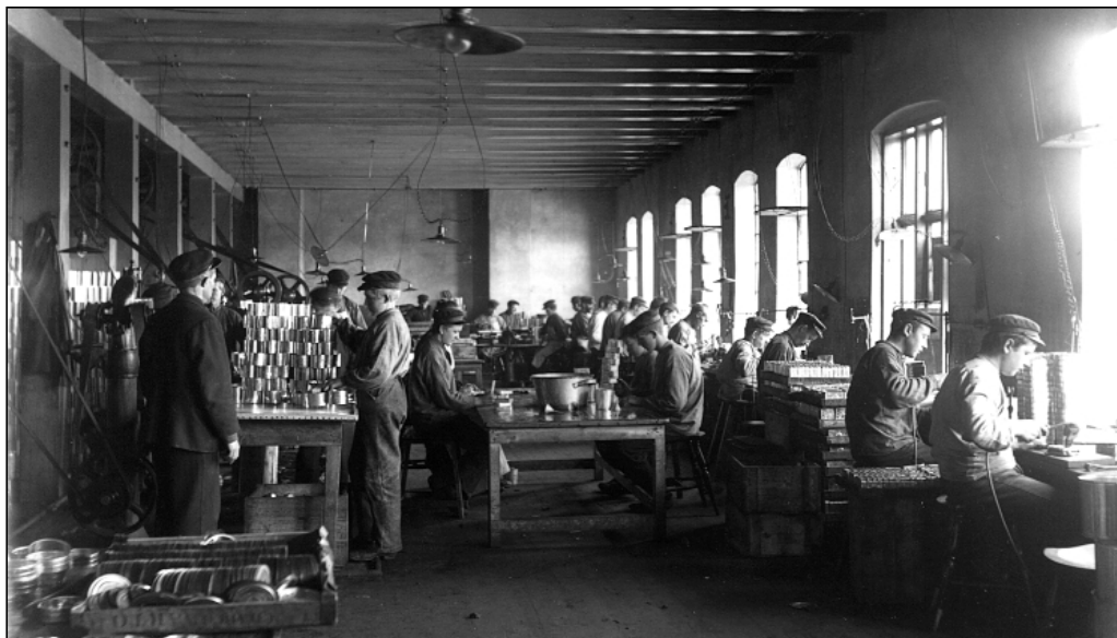
Fra hermetikkindustriens barndom. Fotografiet er tatt ved byens eldste hermetikkfabrikk, Stavanger Preserving. Arbeiderne til høyre er i ferd med å lodde lokk på sardin-eskene. Foto: Statsarkivet i Stavanger
